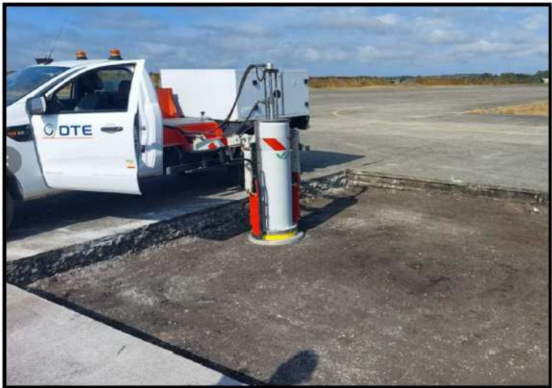
Photo 2: Essais de portance à la dynaplaque
